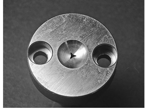
図4 K2機能を付加したハイサイクル用スプルーブッシュ
